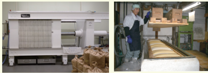
藪田式ろ過圧搾機 [写真: 常山] 佐瀬式の槽型搾り機 [写真: 天明]
