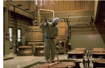
かめ壺仕込みの様子。奥には木桶蒸留器。
